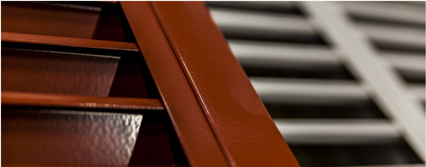
Ytterväggsgaller som nyligen pulverlackerats i korrosivitetsklass C4 och härdats i vår värmeugn.
